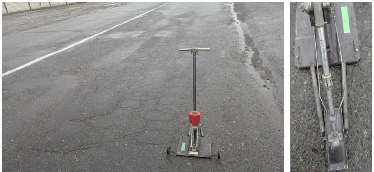
Рисунок 1.2 – Вимірювання коефіцієнта поздовжнього зчеплення з поверхнею дорожнього покриття
