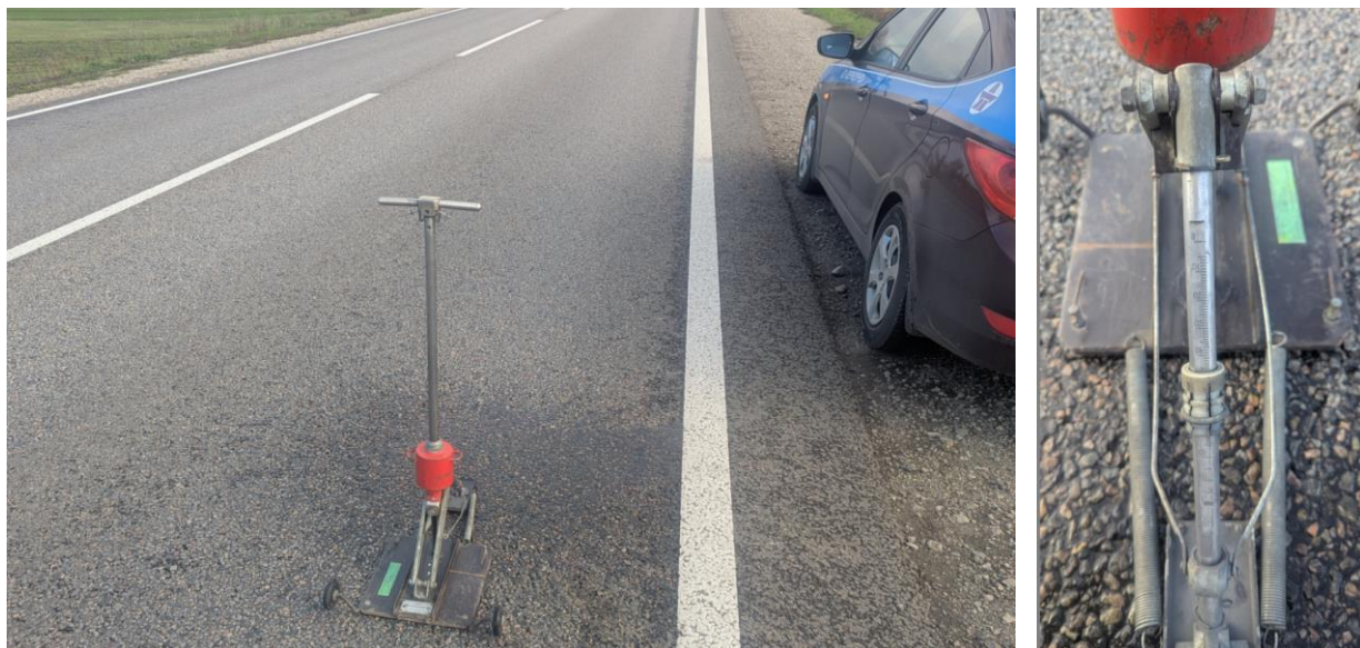
Рисунок 1.2 – Вимірювання коефіцієнта поздовжнього зчеплення з поверхнею дорожнього покритву
