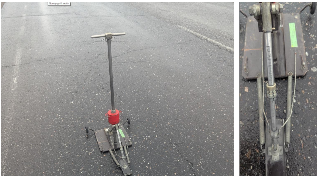
Рисунок 1.2 – Вимірювання коефіцієнта поздовжнього зчеплення з поверхнею дорожнього покриття
